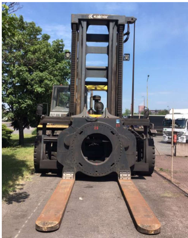
Obr. 6 – Vidlicový vozík pro překládku nebo vykládku kontejnerů Innofreight (autor: Aleš Martinásek, INNOFREIGHT Czech)
