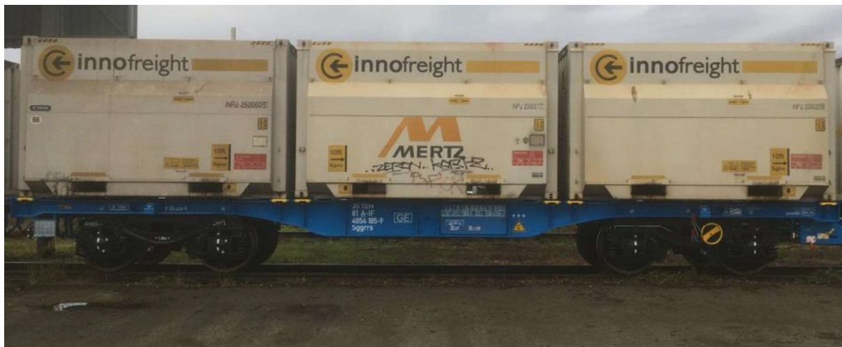
Obr. 7 – Polovina InnoWaggonu řady Sggrs s kontejnery Innofreight typu XM (autor: Aleš Martinásek, INNOFREIGHT Czech)
