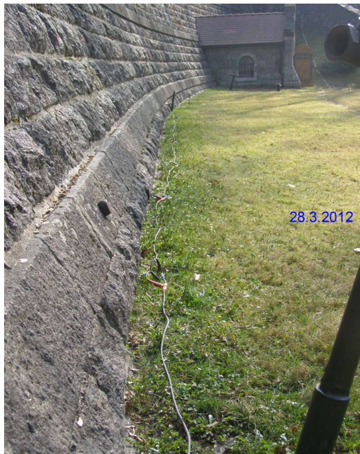
Obr. 3 Geofyzikální průzkum – profily v patě vzdušného líce hráze
