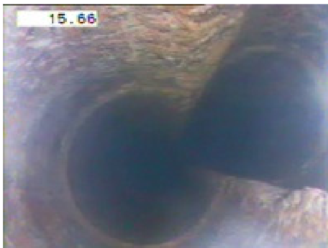
Obr. 5 Rozdvojení vrtu J101 v hloubce 15,96 m (hloubkový údaj na snímku je zkreslený)
