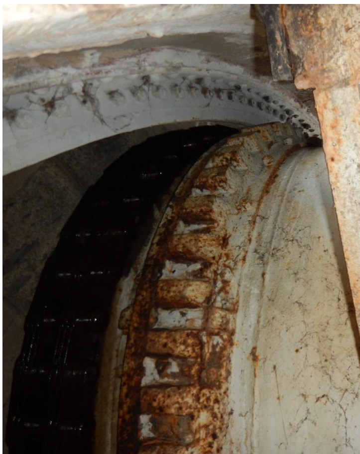
Ozubnicový věnec na levé části
