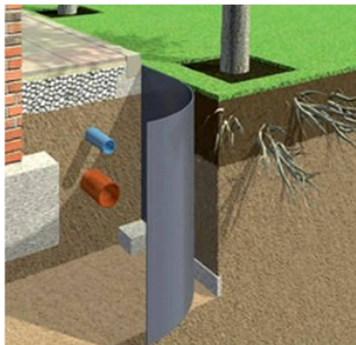
Obr.: Příklady použití a instalace protikořenové fólie ROOTCONTROL ®
