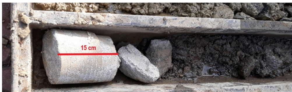
Obr. 6 Vrtné jádro ze sondy KJ-4 - žulová konstrukce původního jezu (Musel, 2021)
