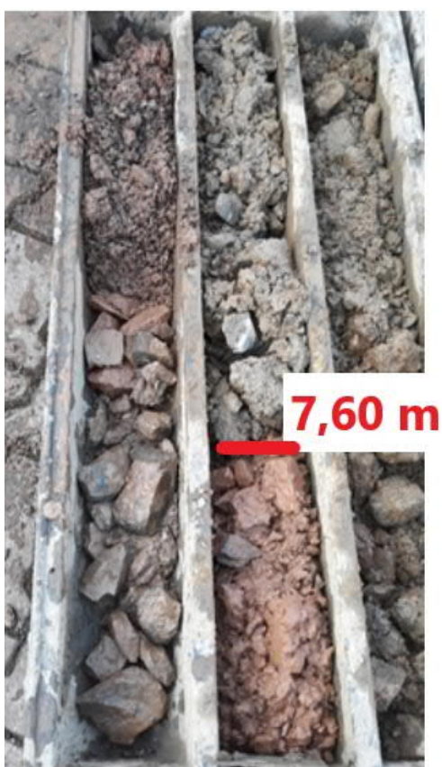
Foto 13 Detail litologického profilu sondy KJ-5, rozhraní fluvialního štěrku a předkvartérního podloží
