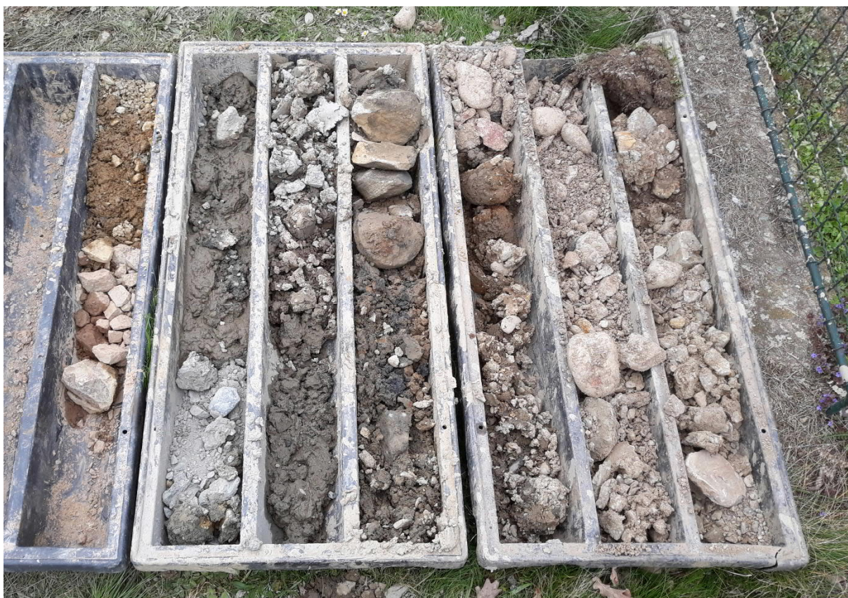
Foto 20 Litologický profil hydrovrtu KHV-1
