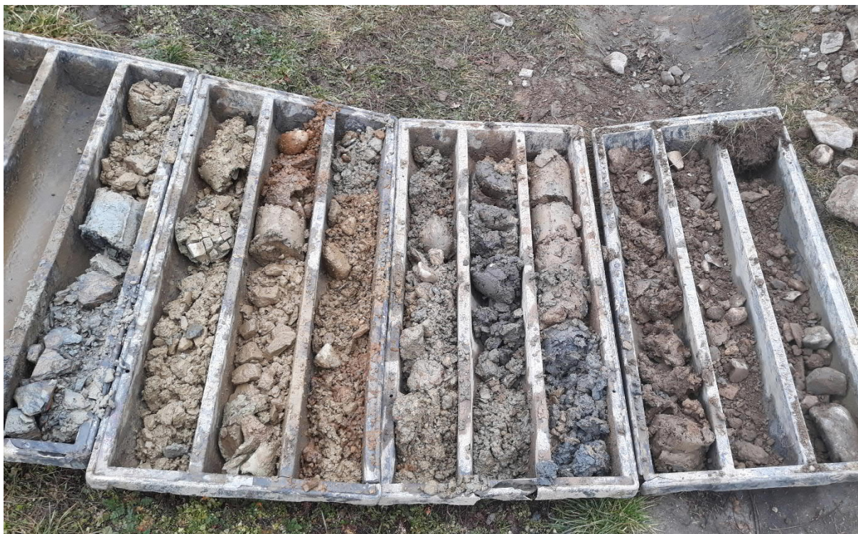
Foto 15 Litologický profil sondy KJ-6
