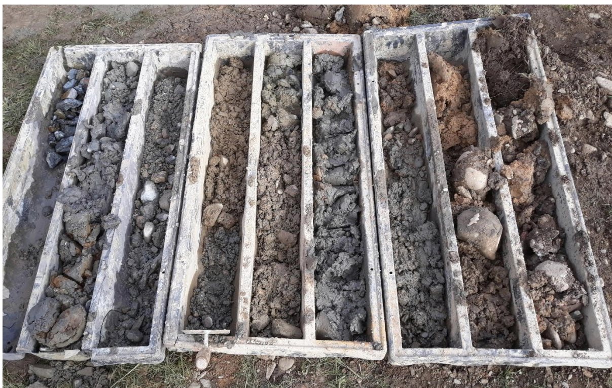
Foto 7 Litologický profil sondy KJ-3 - kvartérní souvrství
