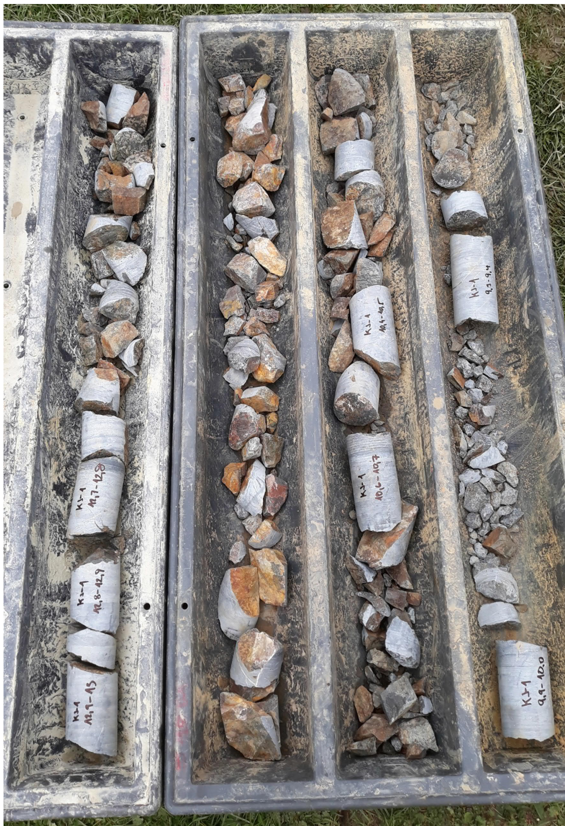
Foto 3 Litologický profil sondy KJ-1 - předkvartérní horniny
