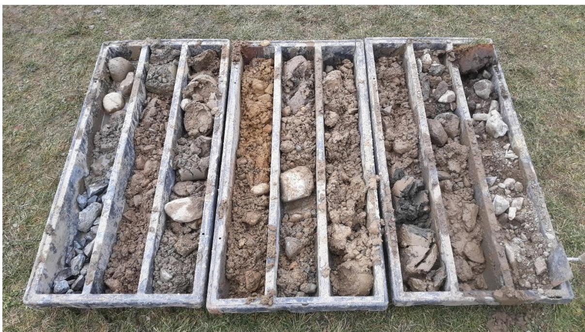
Foto 2 Litologický profil sondy KJ-1 - kvartérní souvrství
