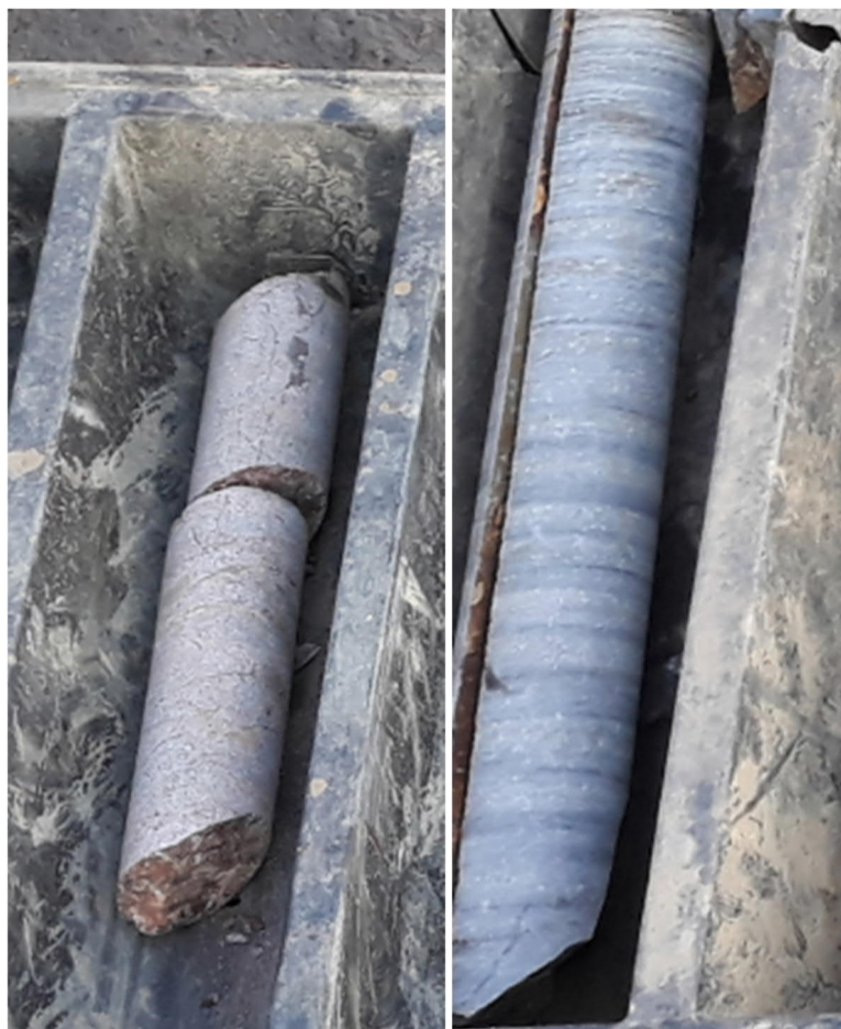
Obr. 8 Vrtná jádra: KJ-7 droba a KJ-3 prachová břidlice (Musel, 2021)
