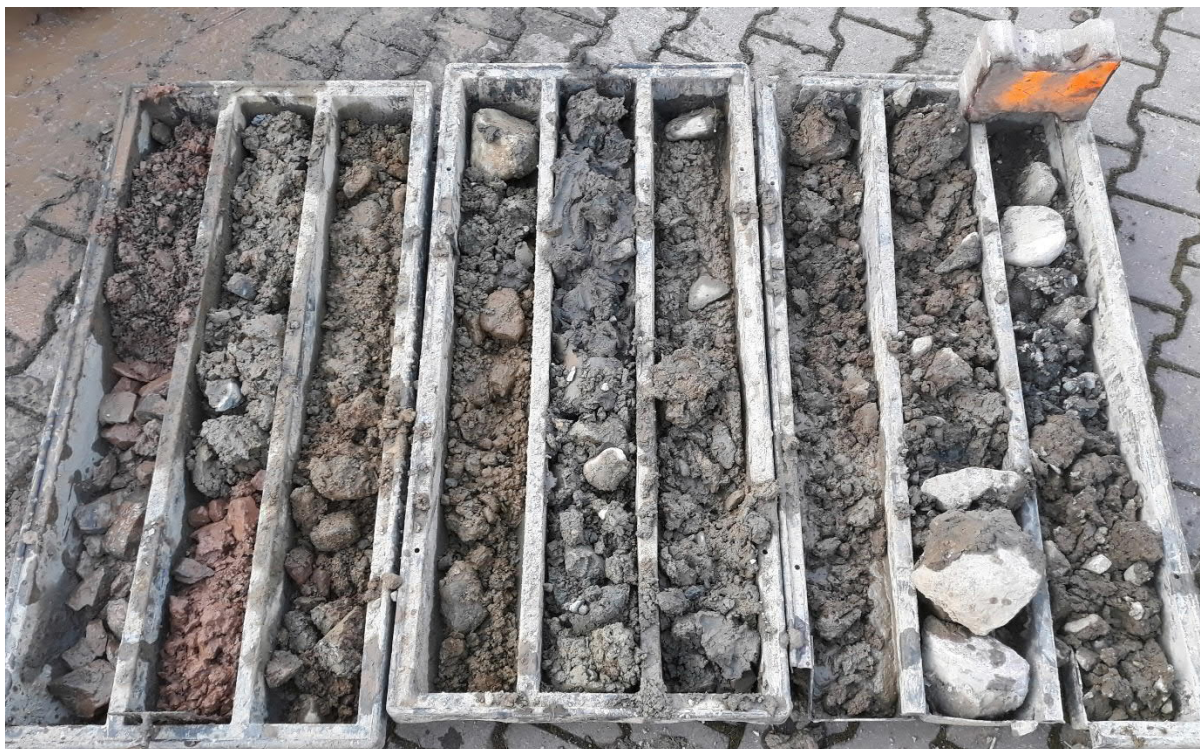
Foto 12 Litologický profil sondy KJ-5
