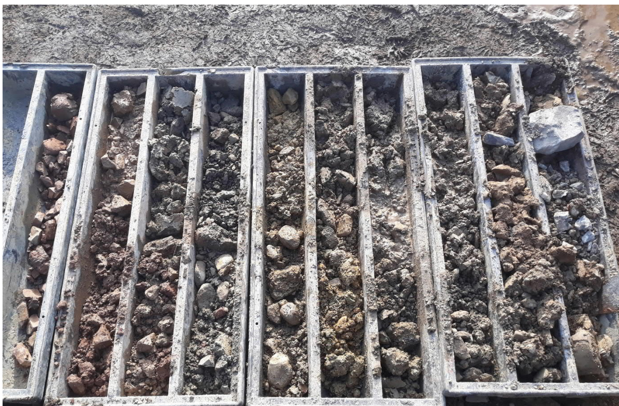
Foto 17 Litologický profil sondy KJ-7 - kvartérní souvrství
