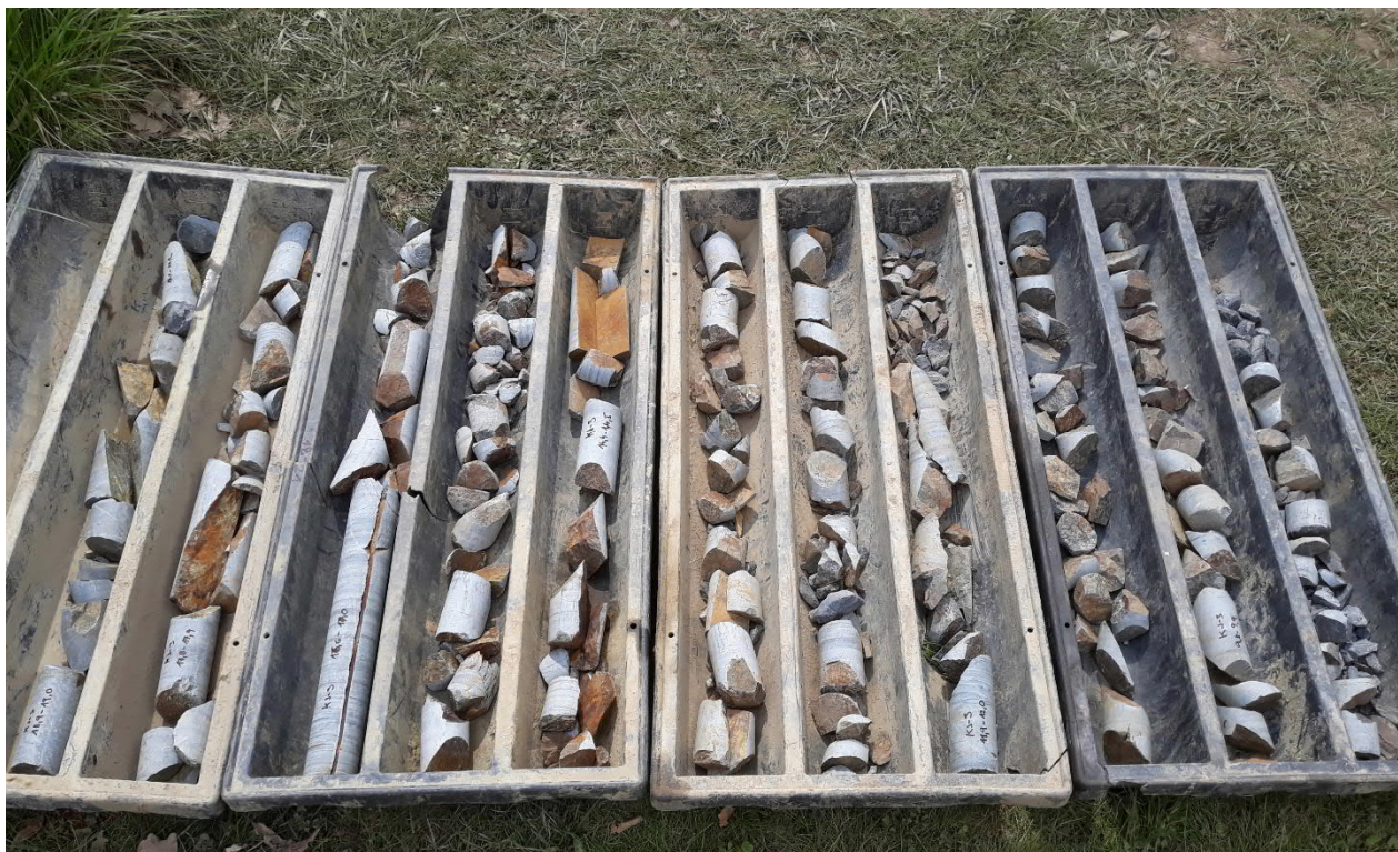
Foto 8 Litologický profil sondy KJ-3 - předkvartérní horniny
