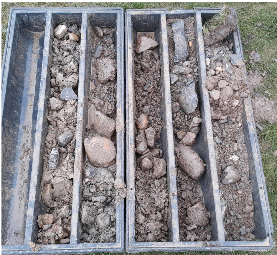
Foto 22 Litologický profil pozorovacího vrtu PV-1
