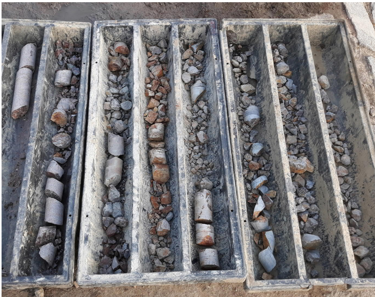
Foto 18 Litologický profil sondy KJ-7 - předkvartérní horniny
