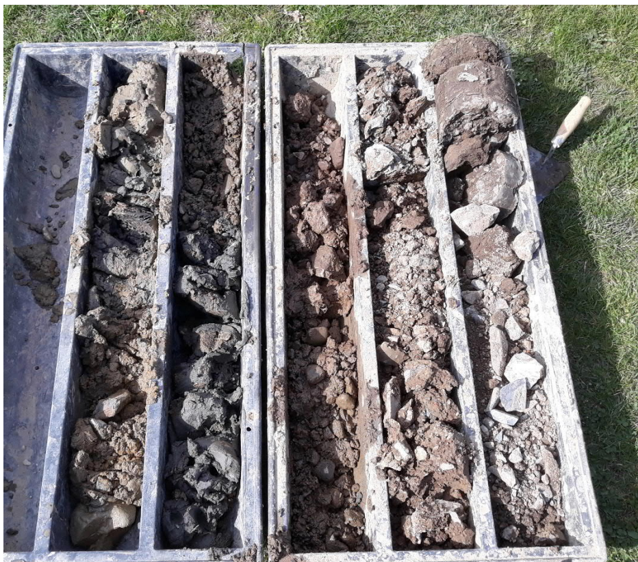
Foto 24 Litologický profil pozorovacího vrtu PV-2
