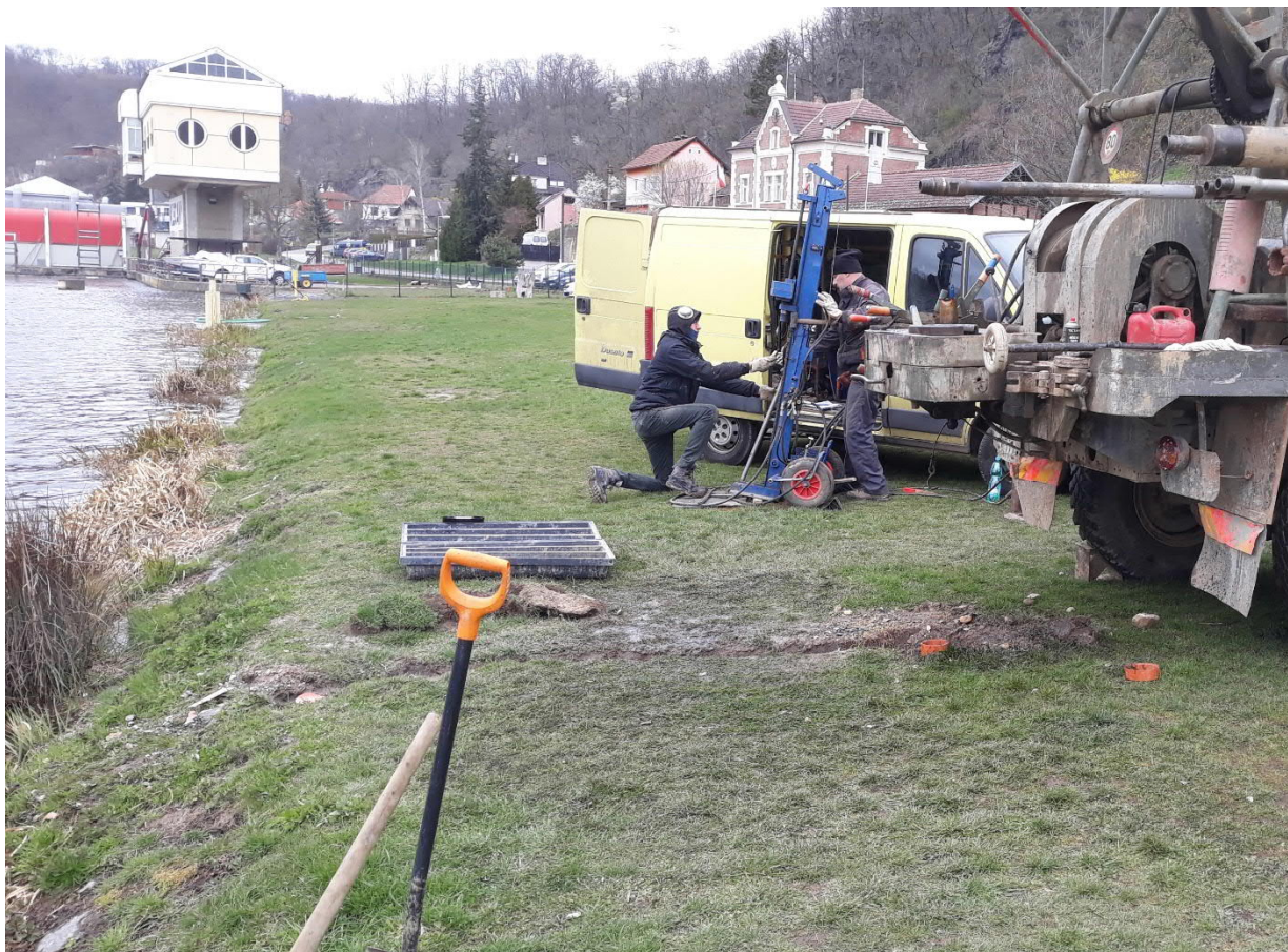
Foto 29 Provádění sond těžké dynamické penetrace - DP1
