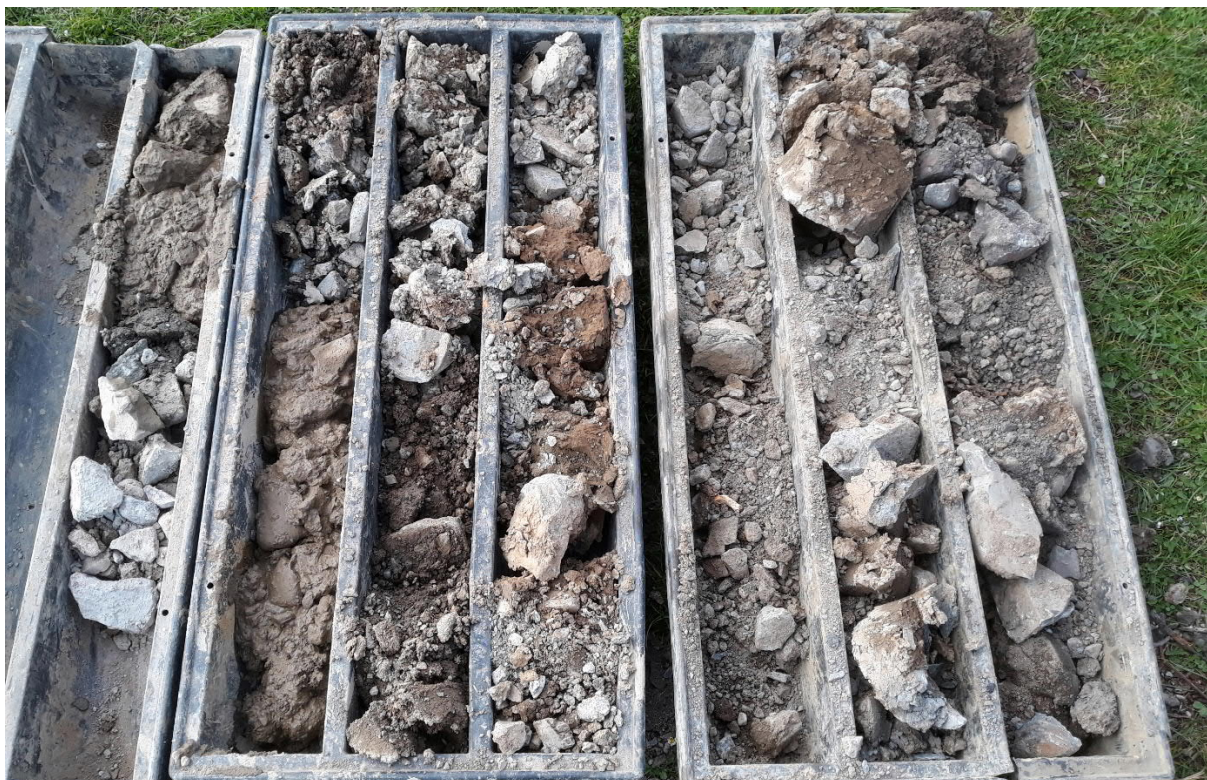
Foto 26 Litologický profil pozorovacího vrtu PV-3
