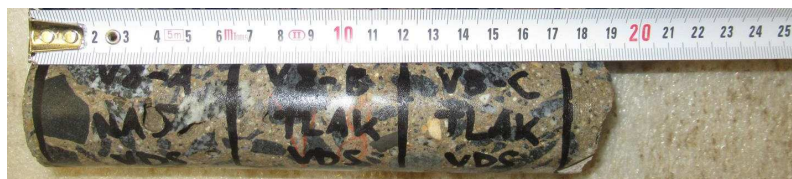
Obr. 2.8 – vývrt V8, strojovna 7B-b, úložný práh 7B, 3,0 m z levé strany. Vývrt obsahuje vyvážený podíl DK a HDK, místy zaznamenány oblasti s převažujícím podílem HDK nad DK. Vývrt též obsahuje ojedinělá zrna HTK. Max. velikost zrna HTK je 18 mm, max. velikost zrna HDK je 47 mm. Beton je hutný až mírně pórovitý.
