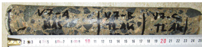
Obr. 2.7 – vývrt V7, strojovna 7B-b, úložný práh 7B, 1,0 m z levé strany Vývrt obsahuje vyvážený podíl DK a HDK, místy zaznamenány oblasti s převažujícím podílem HDK nad DK. Vývrt též obsahuje ojedinělá zrna HTK. Max. velikost zrna HTK je 25 mm, max. velikost zrna HDK je 37 mm. Beton je hutný až mírně pórovitý.
