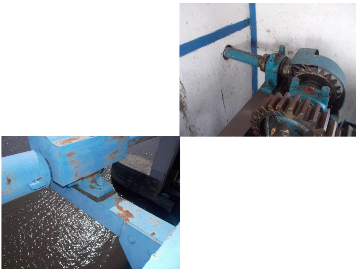
Nízký podkladek, kuželový převod mezi transmisí a zdvihadlem
