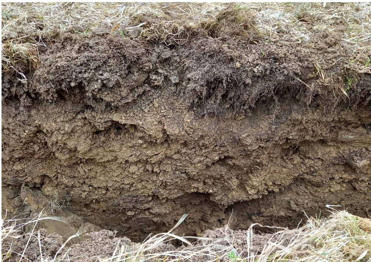
Foto 26 Boční profil kopané sondy BK-13, suťové zeminy jsou bezprostředně pod vrstvou humózní hlíny (Musel, 6. 4. 2022)
