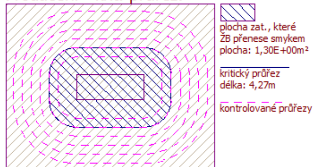
Protlačení - krit. průřez:
