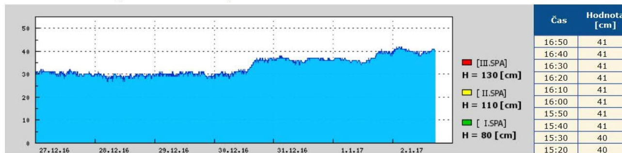
Obr.: Výstupní údaje o hladinách z hladinoměru H1 (Městské rameno - Pitrův most)
