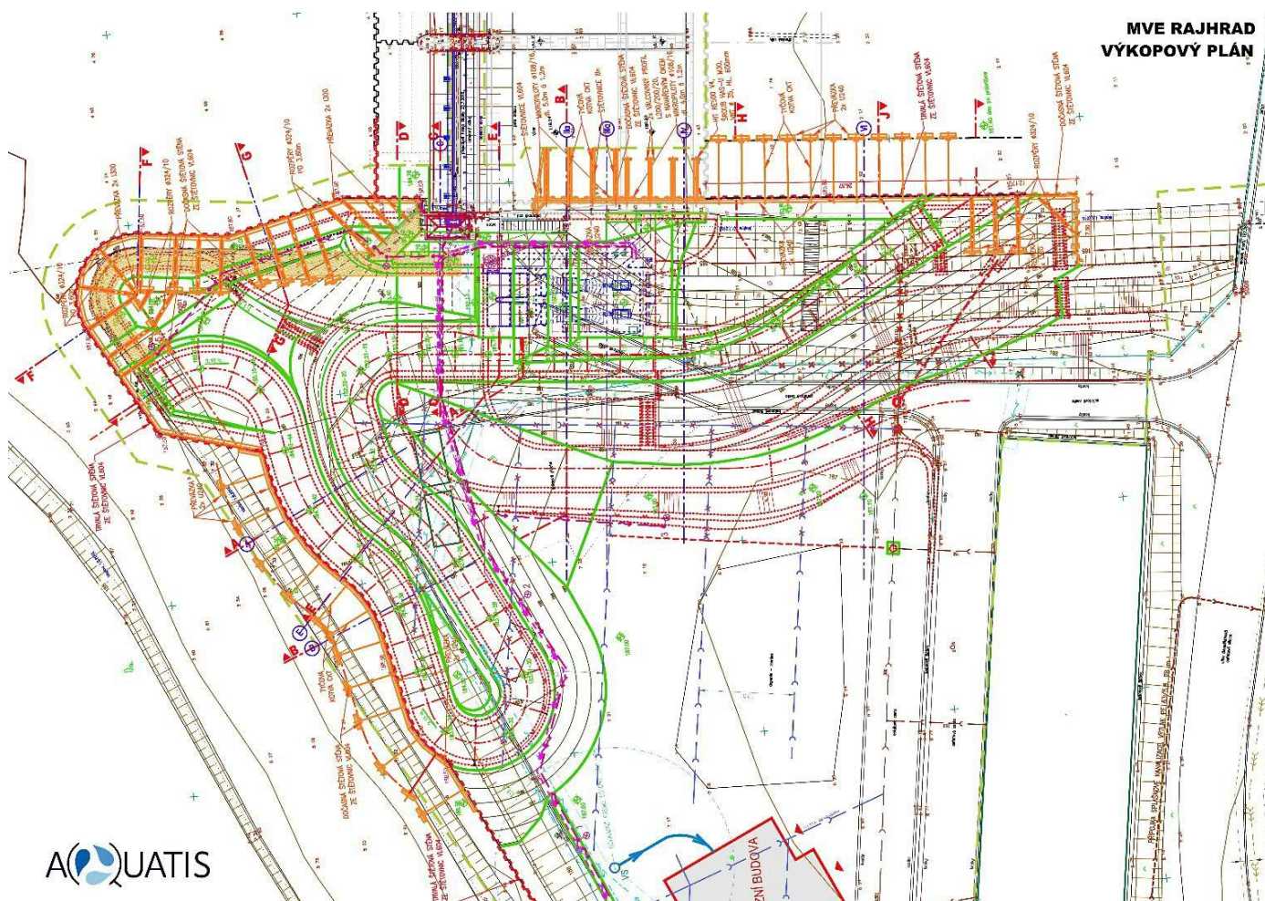
Obr.: Výkopový plán pro stavbu MVE s rybím přechodem podle DPS.
