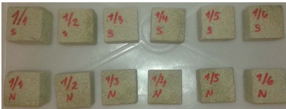
Obr. 11. Vyrobená zkušební tělesa z odebraného vzorku staviva
