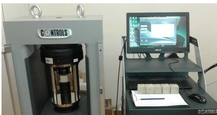
Obr. 12. Vzorek staviva ve zkušební lisu
