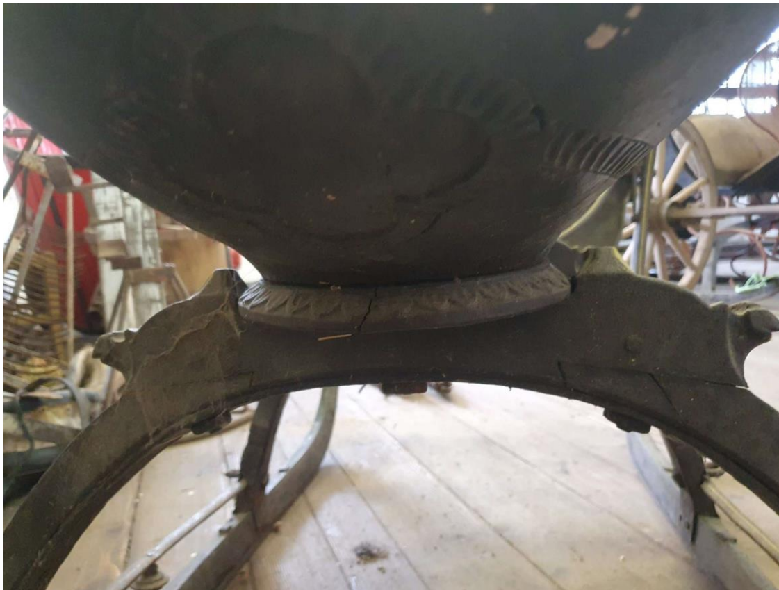
Obr.č.7 Detailní snímek spodní vyřezávané části pod sedákem s centrálním motivem. Detailní pohled na uchycení sedáku ke spodní části se skluznicemi
