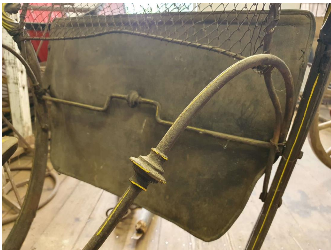
Obr.č.4. Na detailním snímku pohled na přední část saní. Na snímku masivně poškozená konstrukce pletivy a poškozená spodní část kožené přední stěny.
