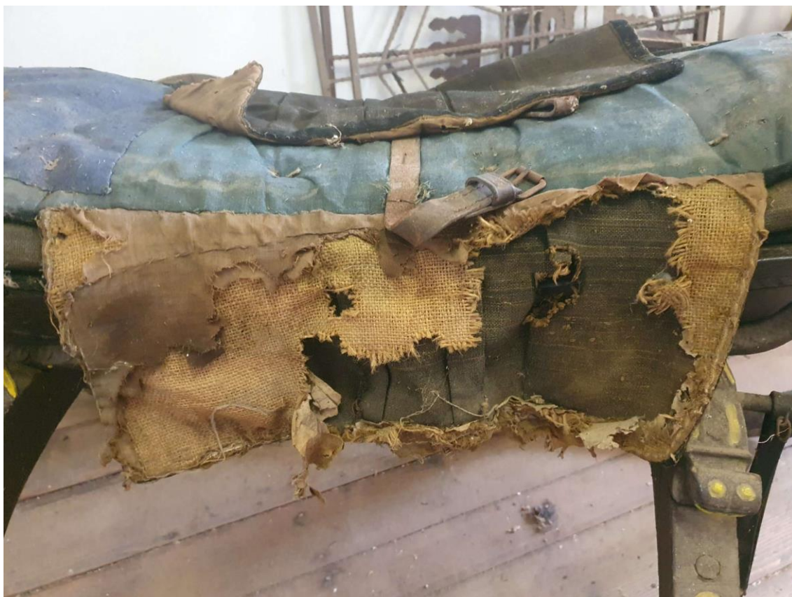
Obr.č.20. Na snímku poškozená spodní strana boční draperie. Poškozená jutová nosná část i spodní textilie.
