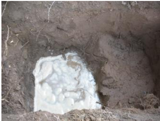
Kopaná sonda nemohla být díky intenzivnímu přítoku vody v požadovaném termínu dokončena
