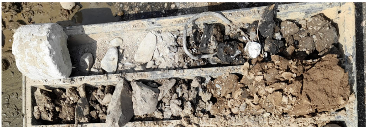
Obr. 5 Vrtné jádro ze sondy DJ-1 – betonové plato, kamenný podsyp a navážka (Musel, 2025)
