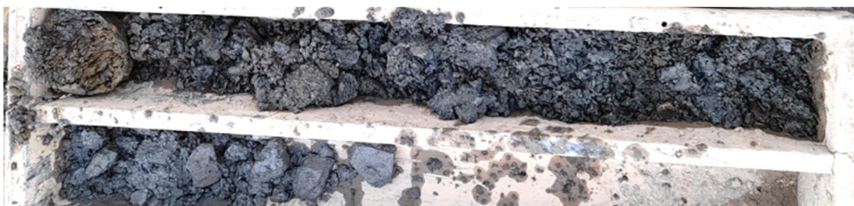
Obr. 8 Vytěžená prachová břidlice geotech. tř. zleva R4 až R2/R3, DJ-2; 9,0 – 10,4 m (Musel, 2025)
